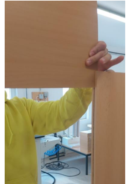
Ezután a vékony HDF hátlapokat becsúztatjuk az előre kialakított mélyedésbe.
